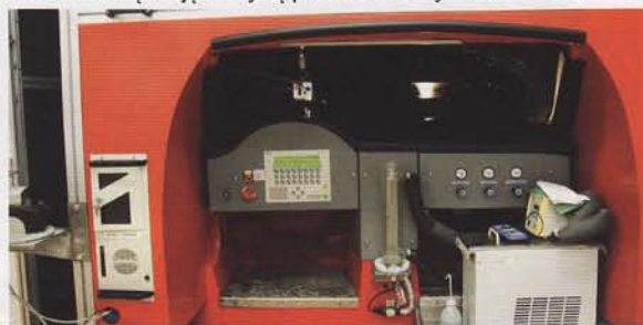
Purvas purškiamas ant įrenginio, o vaizdo kamera fiksuoja nuvalymo greitį
