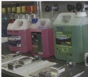
Laboratorijoje nustatoma, ar skystis langams plauti nekenkia plastikui, dažams, lakui ir kitoms medžiagoms
