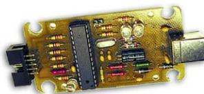
«USB программатор микроконтроллеров
