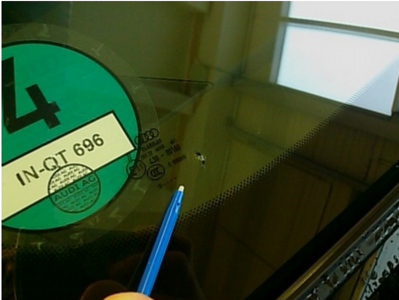
Beschädigung Verglasung: Frontscheibe - Steinschlag - erneuern
