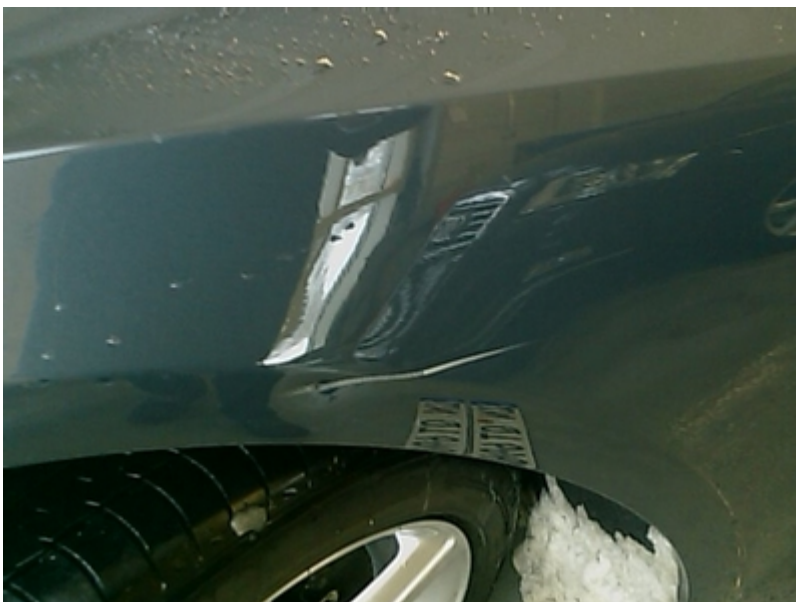
Beschädigung Kotflügel links: Kotflügel links - Dellen / Beulen - instandsetzen und lackieren
