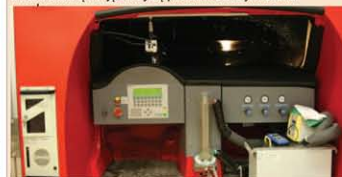
Purvas purškiamas ant įrenginio, o vaizdo kamera fiksuoja nuvalymo greitį
