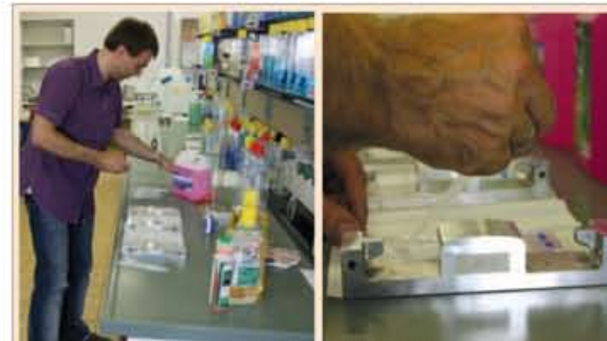
Laboratorijoje nustatoma, ar skystis langams plauti nekenkia plastikui, dažams, lakui ir kitoms medžiagoms
